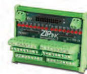
ZL-LTB16-24-1 sensor input module
